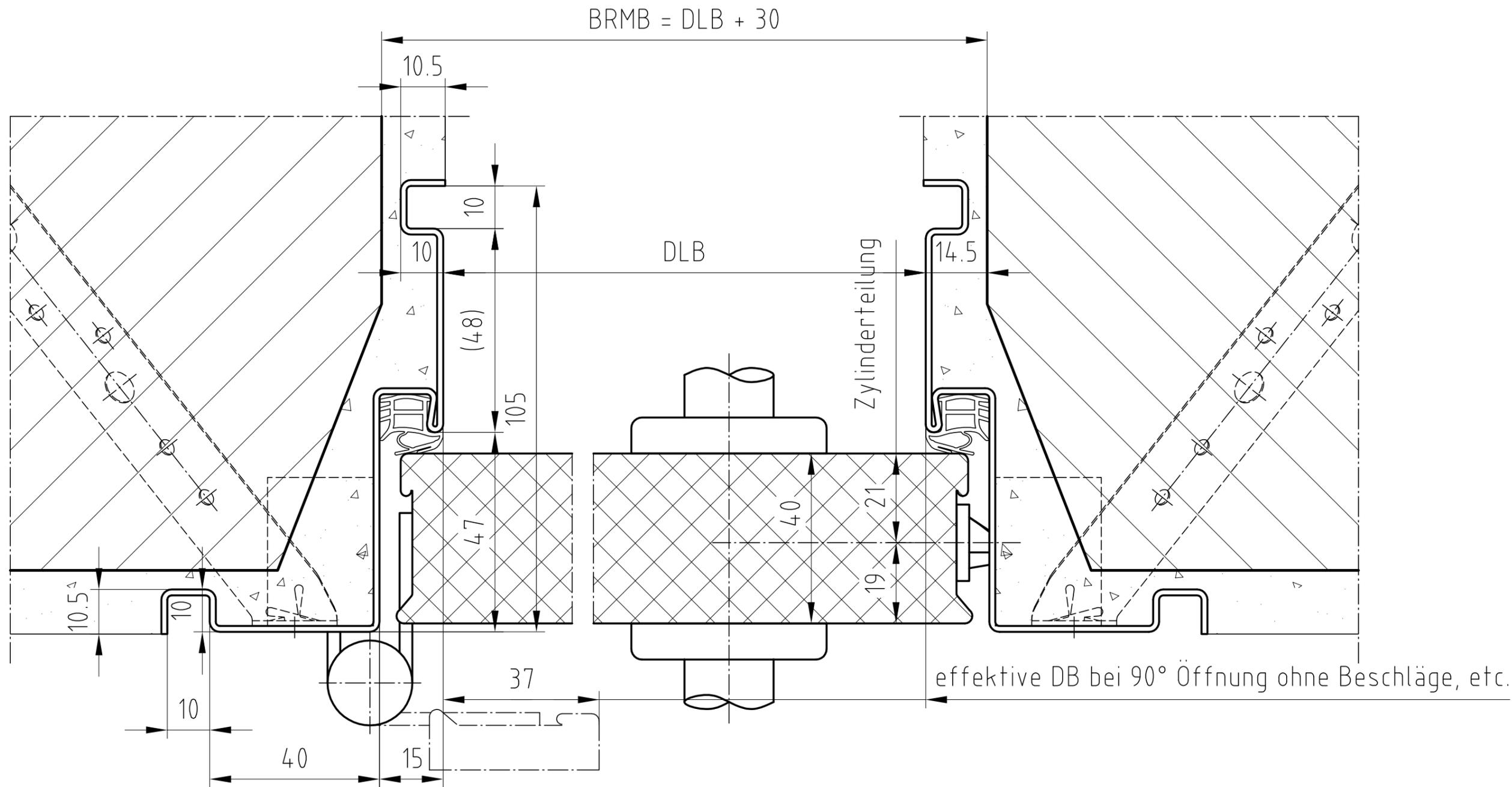
\* ... Durchgangslichtbreite ohne Berücksichtigung von geöffnetem Türblatt und Anbauteilen wie z.B.: Drücker, Balken, Türschließer, usw.
