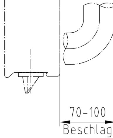
\* ... Durchgangslichtbreite ohne Berücksichtigung von geöffnetem Türblatt und Anbauteilen wie z.B.: Drücker, Balken, Türschließer, usw.
